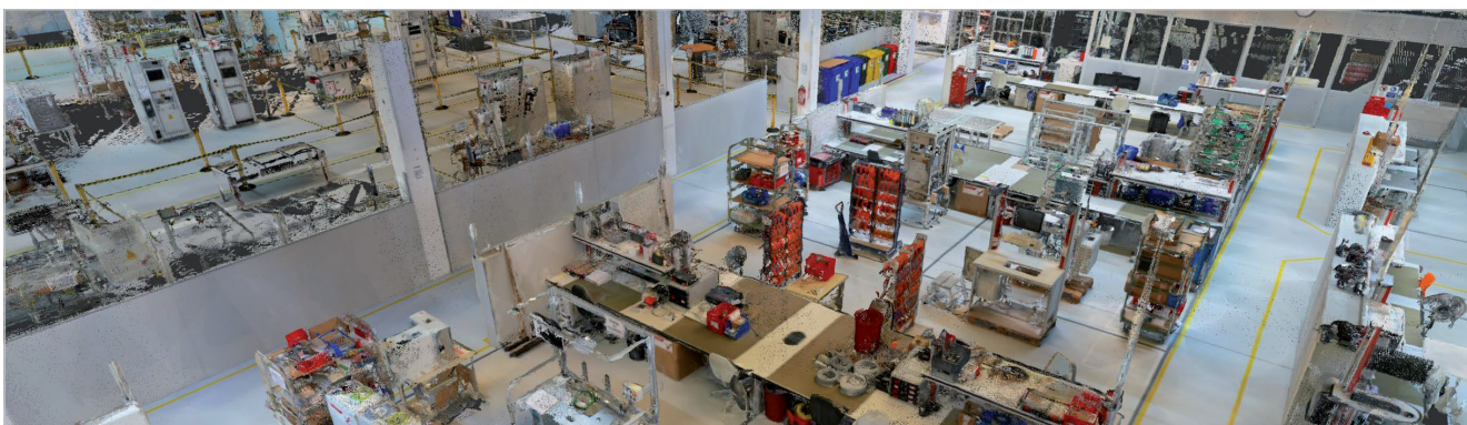
Mračno bodov prevádzky Elabo zoskenované pomocou NavVis M6
